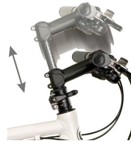
Höhenverstellbares Lenkersystem. Verstelle jederzeit und ohne Werkzeug die Höhe des Lenker (um 100mm bei Rädern und 60mm bei Pedelecs). Passe so auch unterwegs die Sitzposition individuell an, um Schmerzen vorzubeugen oder zu beseitigen.
